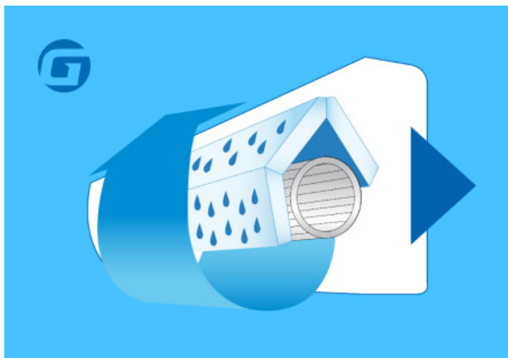
Після вимкнення кондиціонера на теплообміннику внутрішнього блоку залишається конденсована волога
